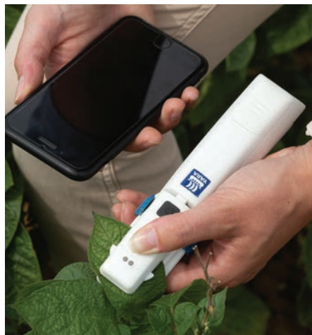
FIGURE 15 : le N-Tester est un outil de pilotage qui permet l'ajustement des apports tardifs d'azote.
