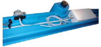
Unité centrale (PC + spectromètres) + antenne GPS
